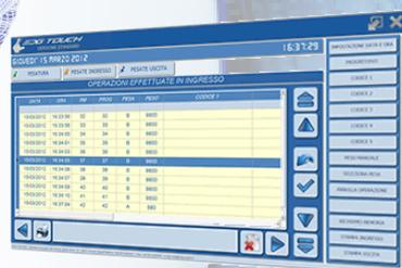
EDG TOUCH prevede l'utilizzo di due fondamentali tabelle di lavoro, operazioni di peso in ingresso e operazioni di peso in uscita. Tale soluzione permette all'operatore una rapida individuazione sia degli automezzi presenti in stabilimento, sia degli automezzi che hanno completato le operazioni di pesatura.
